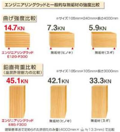
HUCKの柱・梁などの主要構造材には「エンジニアリングウッド（構造用集成材）」を使用しています。エンジニアリングウッドとは、木材がもつ短所を極力減らすために無垢材の良質な部分だけを厳選し、ひき板として積層接着したものです。寸法が安定するうえ、「割れにくい」「反りにくい」「曲がりにくい」「ねじれにくい」などの特長をもつため、品質のバラつきが少なく高い安全性、高品質を実現できます。左図を見てもわかるように、無垢材と比べその強度の差は明らかです。
