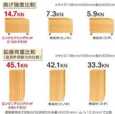
HUCKの柱・梁などの主要構造材には「エンジニアリングウッド(構造用集成材)」を使用しています。エンジニアリングウッドとは、木材がもつ短所を極力減らすために無垢材の良質な部分だけを厳選し、ひき板として積層接着したものです。寸法が安定するうえ、「割れにくい」「反りにくい」「曲がりにくい」「ねじれにくい」などの特長をもつため、品質のバラつきが少なく高い安全性、高品質を実現できます。左図を見てわかるように、無垢材と比べその強度の差は明らかです。
